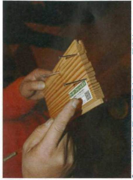
「EDS木材」を用いた群馬県産カラマツ間伐材のフローリングサンプル。収縮が起きにくいという。木口の際に釘を打っても割れない
